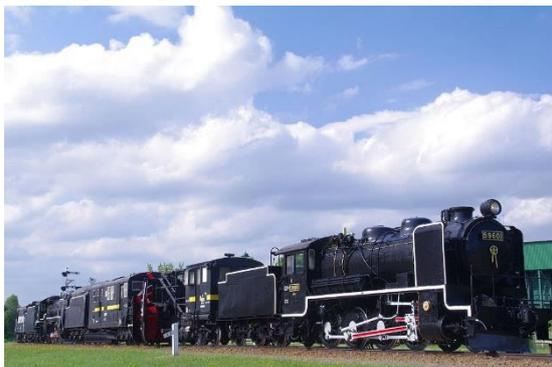
動力となり、マックレー車によって雪の壁を崩して内側にかき集め、ロータリー車によって、搭載されている羽が回転して遠くへ雪が吹き飛ばされる仕組みだ。このSLキマロキ編成がおかれているところが、名寄本線の廃線跡上にあるようだ。列車が走っていたところにそのまま車両が展示されて
